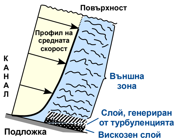
⇐ Фиг. 17.2. Схематичен строеж на движещ се турбулентен флуиден поток (no Slingerland & Smith, 1986)
