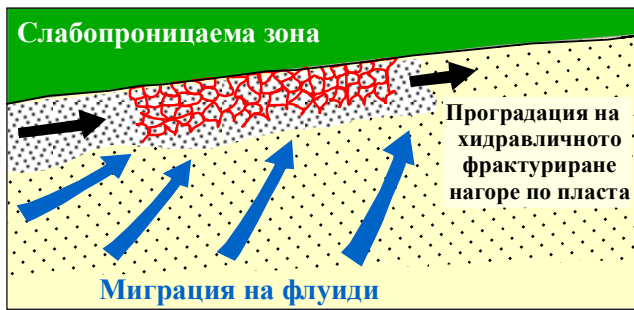
Фиг. 11.9. Хидравлично фрактуриране в седиментен басейн: флуидите се натрупват под непроницаеми зони, напр. шейли или евапорити, поровото налягане нараства и се стига до брекчиране, което проградява нагоре по пласта (no Evans, 1993)
