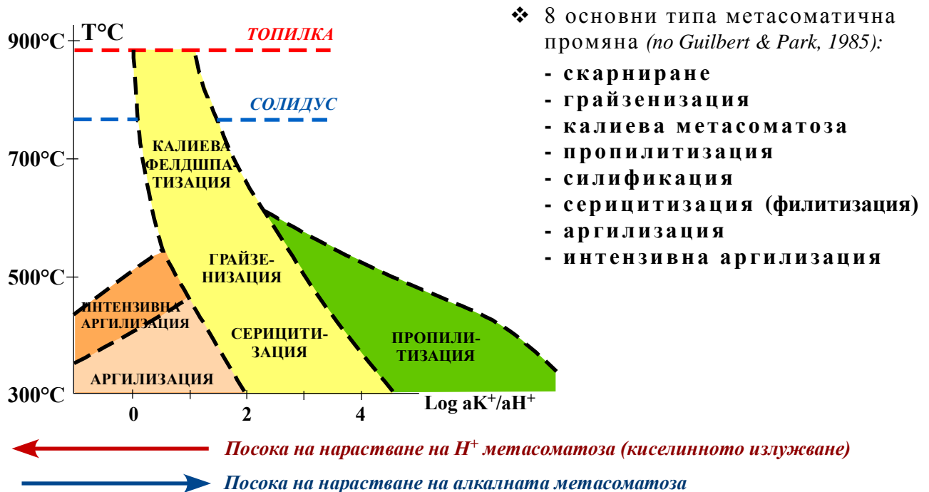
Фиг. 12.2. Видове хидротермални изменения в зависимост от температурата и активностите на K^+ и H^+ при налягане 1 kb (дълбочина 3-4- km) (no Guilbert & Park, 1985; Burnham & Ohmoto, 1980)
