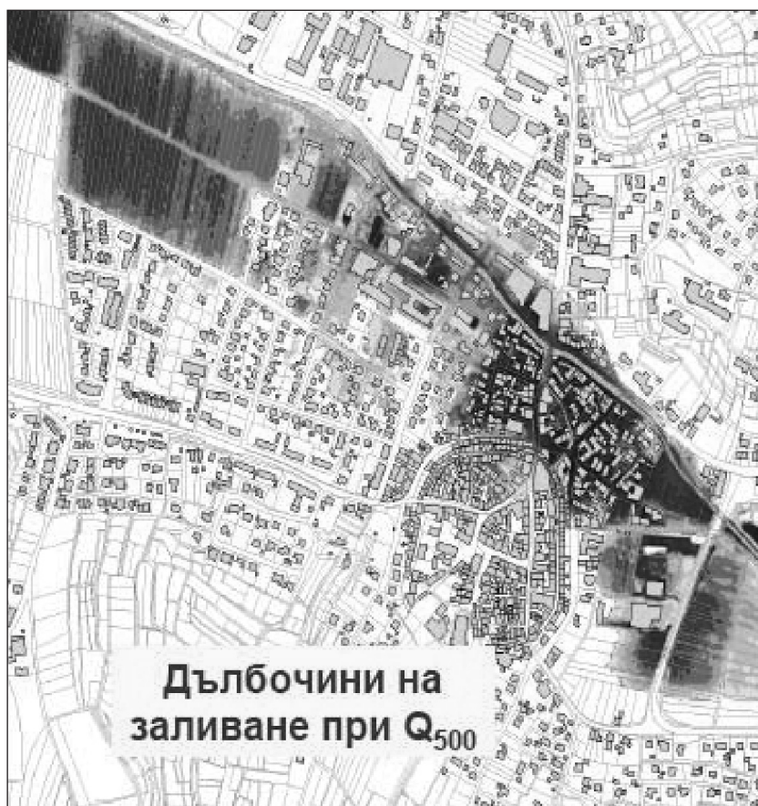
Фиг. 6. Определяне височината на водния стълб при наводнение Fig.6. Determining the height of water column in flood
