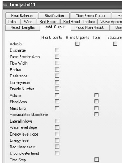
Фиг. 7. Меню за допълнителни данни, включени в изходящия файл Fig. 7. Menu for additional data included in the output file
